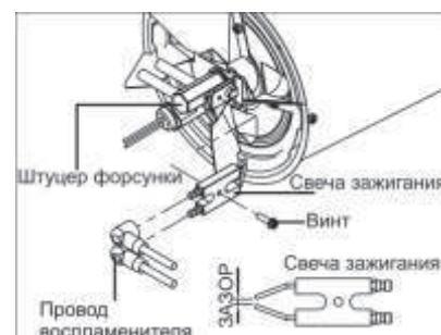
Рис. 16 Регулировка зазора электродов
