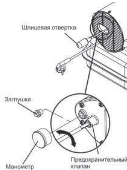
Рис. 19 Регулировка давления насоса
